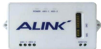
Централизованный конвертер Modbus
